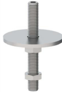
Configurazione del martinetto prima dell'inserimento sull'antivibrante
